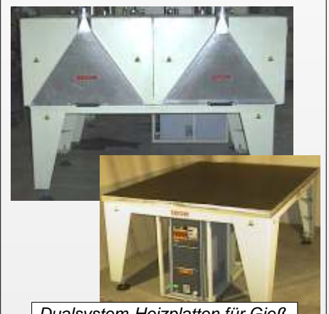
Dualsystem-Heizplatten für Gießtische und grossflächige Anlagen mit hoher Temperaturgenauigkeit
