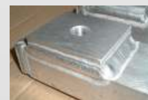
Geschweißtes Aluminium-Profilsystem mit top-Verarbeitung / Detail Anschluß
