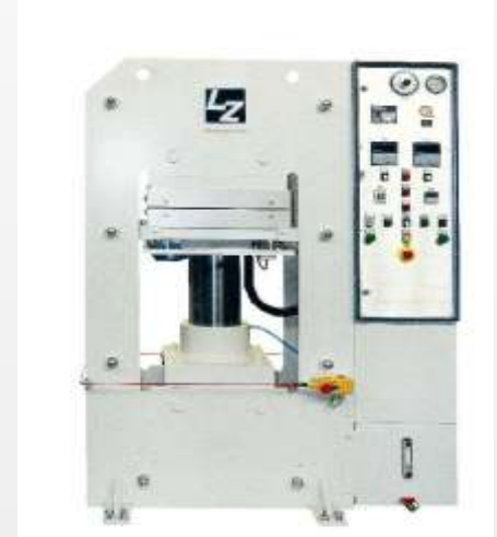
ELKOM-Fluidtherm als Hochtemperatursystem mit Kühloption in einer Laborpresse
