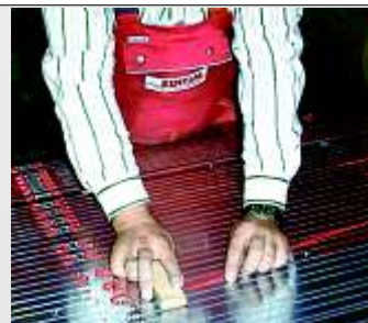
Qualität bis in's Detail: "Kehren" in der Plattenmitte ermöglichen die thermische Ausdehnung des Aluminiums ohne den Heizleiter zu gefährden. (Bild zeigt die Produktionsphase "Heizleitereinbau")
