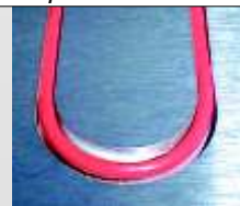
Qualität bis in's Detail: "Kehren" in der Plattenmitte ermöglichen die thermische Ausdehnung des Aluminiums ohne den Heizleiter zu gefährden. (Bild zeigt die Produktionsphase "Heizleitereinbau")
