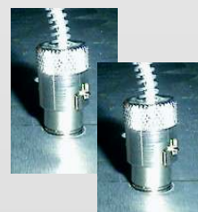
Spezialmeßfühler PT 100 in der Heizplattenrückseite eingebaut . ( 4 x pro Platte für die Arbeitstemperatur / 1 x pro Platte für die Sicherheitstemperatur)
