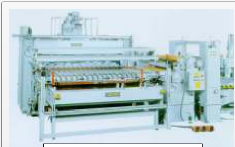
ELKOM Kurztaktheizplatten für alle Durchlaufpressen und Hochleistungspressen
