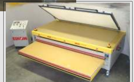
MULTITHERM mit geöffneter Schublade der Vorheizstation und geöffnetem Membranrahmen
