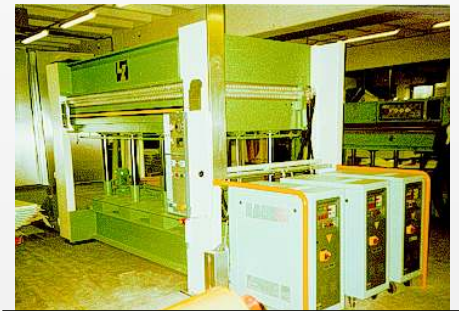
ÖKOTHERM-PLUS in der Praxis : Hochpräzise Heiz-Kühleinheit mit drei Heiz-Kühlmaschinen in einer Mehretagen- presse für Flugzeugbauteile
