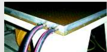
Beispiel : Heiz-Kühltisch mit Vakuum-Saugbohrungen im Raster 40x40 mm
