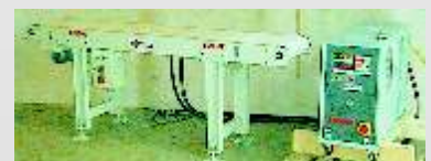
Beispiel : Kühltisch mit Kühlaggregat und Transportband für die Kühlung von Serienbauteilen
