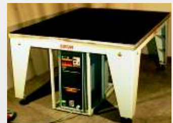
Beispiel : Gießtisch für Polyurethan mit Heizkühlmaschine
