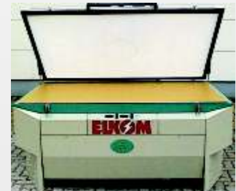
Vakuumpresse (heiz- und kühlbar bis zu 250 ° C)
