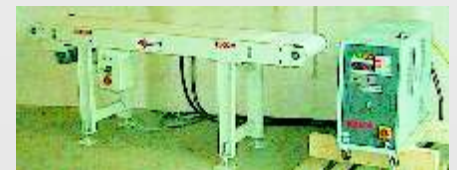
Kühltisch mit Transportband und Antrieb mit komplettem Kühlaggregat
