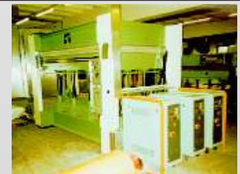
Heiz-Kühlplattenanlage mit drei Heiz-Kühlgeräten
