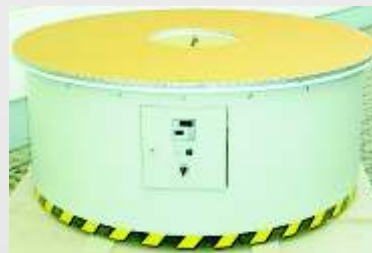
Elektrischer Rundheiztisch mit Antrieb durch Getriebe für die Polyurethanschäumtechnik
