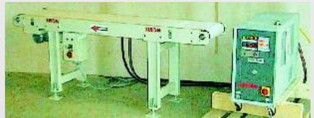
Kühltisch mit angetriebenem Transportband ÖKOTHERM-Kühlplatte und Wasserkühlgerät
