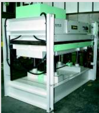
Furnierpresse mit ÖKOTHERM Heizplatten und Temperiergerät im Pressenoberteil eingebaut
