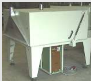
Gießtisch für Heißpolymer mit Abdeckhaube ÖKOTHERM-PLUS-Heizplatte und Druckwassertemperierung
