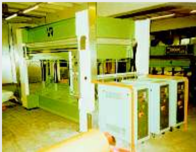
Heizkühlpresse mit drei ÖKOTHERM-PLUS-Platten und drei Heizkühlgeräten
